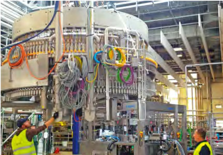
Im Hintergrund steht schon die Etikettiermaschine, der neue Füller mit dem Kabelwirrwarr hängt noch am Kran.
